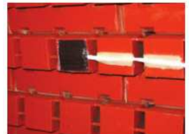
Датчик TFProbe Iris Power, приклеенный к зубцам статора
